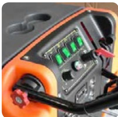
Leva di comando per azionamento spazzola ed erogazione soluzione detergente. Chiave per accensione/ spegnimento ed esclusione batteria, interruttore motore spazzole e motore aspirazione, manopola per dosare detergente (optional), disgiuntore termico per proteggere il motore spazzole e aspirazione, indicatore livello batteria, contatore (optional).
