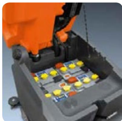
Grande autonomia grazie a 4 batterie da 6V 180Ah di elevata capacità che garantiscono tempi di lavoro in continuo fino a 4.5 h. Possibilità di montare anche 2 batterie da 12V. Minor consumi grazie alla trazione posteriore. Serbatoi in polietilene ad alta resistenza agli urti e agli acidi e di ampia capacità (85 l. reali), che evita frequenti soste per il riempimento.
