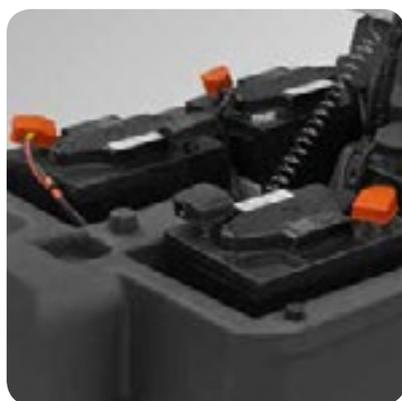
Il serbatoio soluzione detergente serve anche da scomparto batterie, consentendo l'alloggiamento di batterie di elevata capacità che garantiscono tempi di lavoro in continuo fino a 4-5 ore. Serbatoi in polietilene ad alta resistenza agli urti e agli acidi e di ampia capacità (110 l.), che evita frequenti soste per il riempimento.
