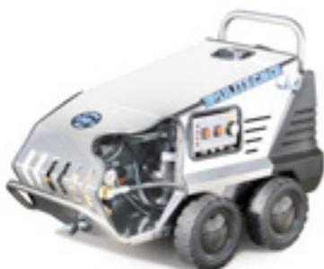
Idropultrice industriale a caldo con **telaio e cofano in acciaio inox**. Possiede pompa a 3 pistoni in ceramica con sistema biella-manovella e testata in ottone. **Comando a distanza TSI (Total Stop Intelligente)** con arresto in caso di micro perdite, mancanza di acqua e arresto bruciatore per mancanza di gasolio. Rimozione facilitata del serbatoio del gasolio. Produzione acqua calda.
